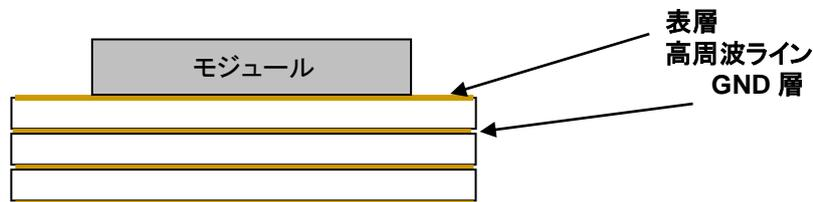
各層の GND パターンは、多くのビアで内層の GND 層に接続して下さい。
