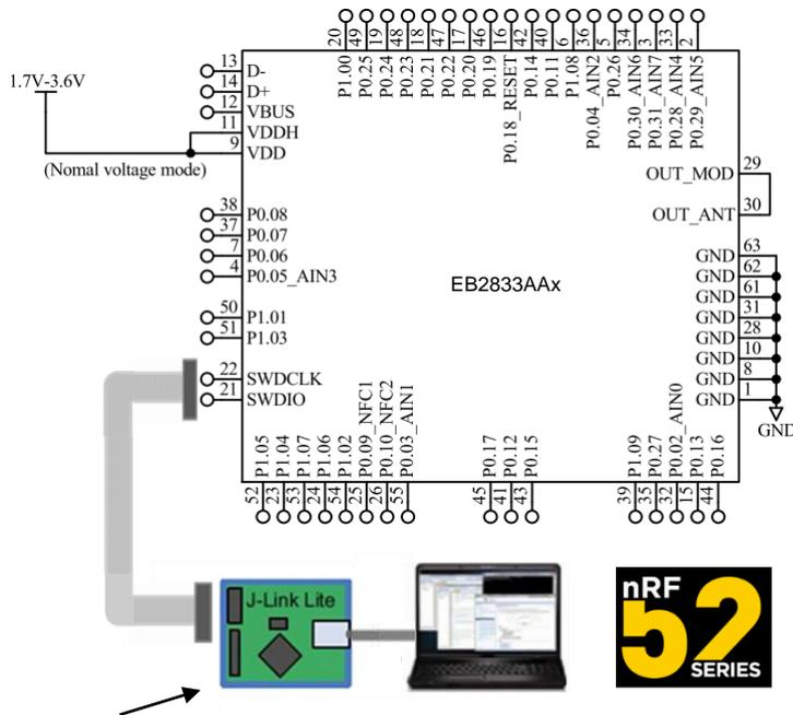
モジュールの内蔵アンテナを使用する為には、PAD29-PAD30 を結線する必要があります。お客様にて基板をご設計される際は、下図をご参考に最短となるよう結線して下さい。
